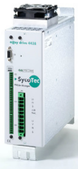
Type : 4438 230 V AC 3,8 KVA max: 16,5 A ≤ 5333 Hz
